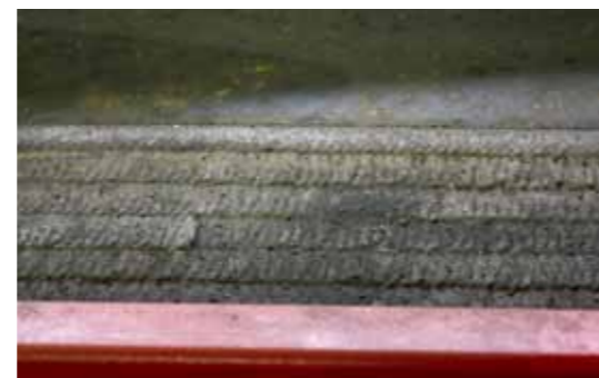
A hegesztéssel felvitt kopásálló bevonat egy k+f projekt részeként lett kifejlesztve
